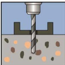
Bohrloch dreh-schlagend bis zur erforderlichen Bohrlochtiefe erstellen
