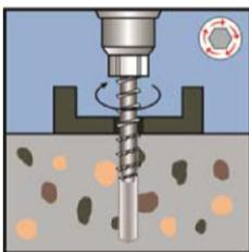
Setzen des Schraubankers mit Tangential-Schlagschrauber oder von Hand
