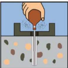
Bohrmehl entfernen, z.B. durch ausblasen
